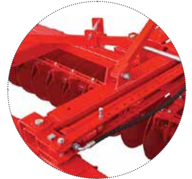
Hidrolik Kumanda ile Açığı Verebilme
